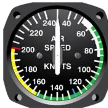
Les vitesses de décrochage ( $V_s$ ,  $V_{so}$ )
